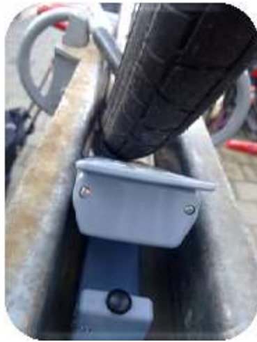
Een fiets maakt contact met een schakelaar
