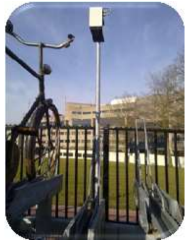
Een ontvanger zendt de informatie door naar een centrale computer
