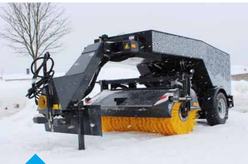
Fabrikant Aebi Schmidt werkt aan een machine (de Nido Velocity) die sneeuwplougen, borstelen en zoutsproeien combineert in één gang.
