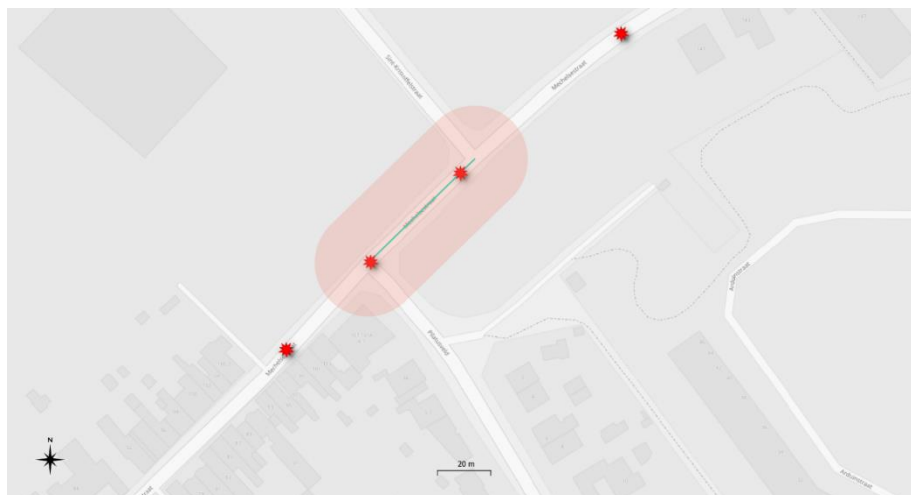
Figuur 3 Illustratie van de koppeling van ongevallen aan een Telraam-segment. De rode sterretjes duiden de fietsongevallen aan; de groene lijn bakent het Telraam-segment af, met in het rood de buffer met straal van 20 meter rond het segment. Alle ongevallen binnen de buffer worden gekoppeld aan het Telraam-segment.
