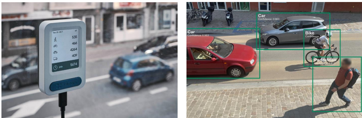
Figuur 2 Telraam sensor S2 en detectie van verkeersdeelnemers (Bron: https://telraam.net/ ).
