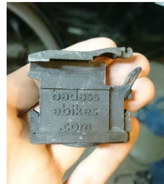
Afbeelding 3 - Met deze module is een elektrische fiets met Bosch motor in enkele momenten opgevoerd.
