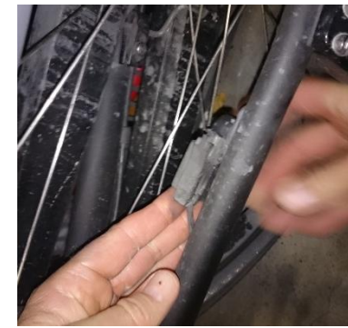
Afbeelding 3 - Met deze module is een elektrische fiets met Bosch motor in enkele momenten opgevoerd.
