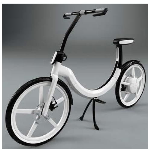
Figuur II, prototype van de VW Bik.e, een opvouwbare elektrische scooter van minder dan 30 kg. die, in opgevouwen toestand, precies in de ruimte voor het reservewiel past.
