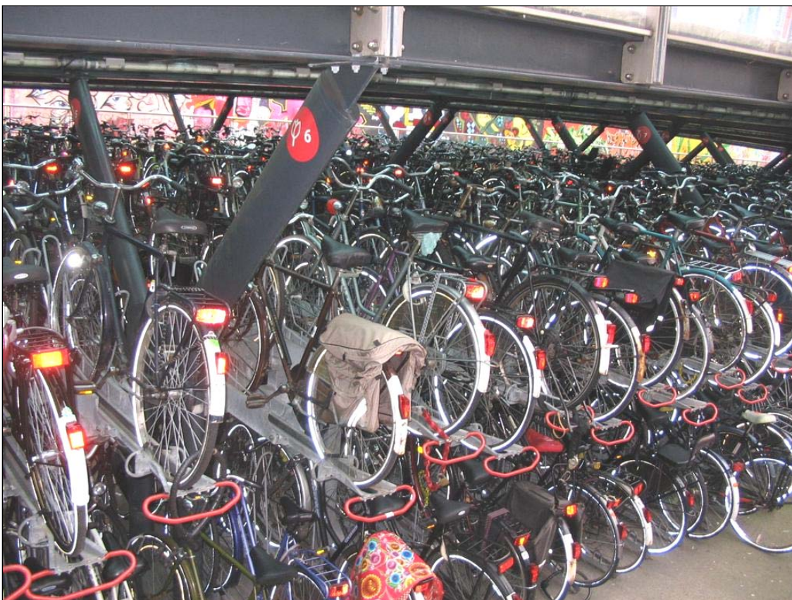
Stallinglocatie 6 heeft etagerekken met uitschuifgoten.
