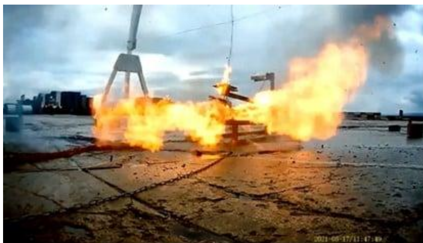
Figuur A.2 Fakkels uit 1,7 kWh batterijmodule (Christensen, 2022)
