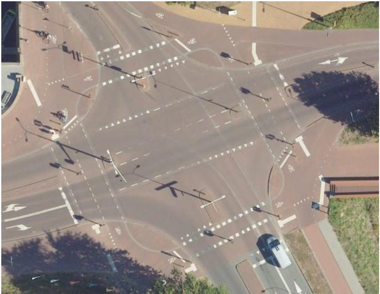
Figuur 20. De gemeente 's-Hertogenbosch kent twee voorbeelden van variant 3, namelijk op het kruispunt Zuidwal-Pettelaarseweg (foto) en Graafseweg-Van Grobbendoncklaan. Een detailverschil is dat op de deelskruispunten geen zebrapaden zijn toegepast op de toeleidende fietspaden. De gemeente heeft aangegeven tevreden te zijn over het functioneren. De weggebruikers zijn positief en er zijn geen klachten bekend: het werkt goed, het is veilig, duidelijk en begrijpelijk, het ondersteunt het informele gedrag van fietsers en het biedt comfort en een vlottere doorstroming voor de grote aantallen fietsers op de hoofdfietsroute, aldus de gemeente.
