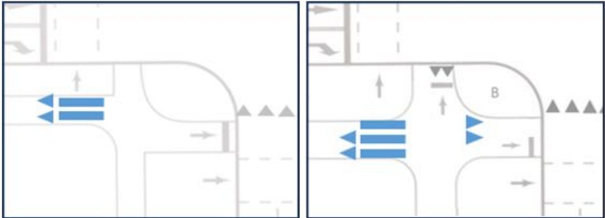
Figuur 13. Schematische weergave van de locatie van het zebepad en haaietanden (links bij eenrichtingsverkeer, rechts bij tweerichtingsverkeer)
