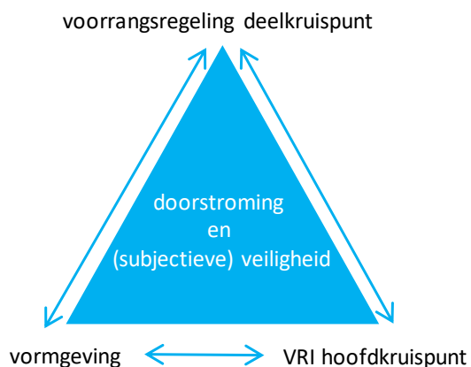
Figuur 3. De voorrangsregeling op het deeldkruispunt moet in samenhang gezien worden met de vormgeving van het kruispunt en de afstelling van de VRI op het hoofdkruispunt.
