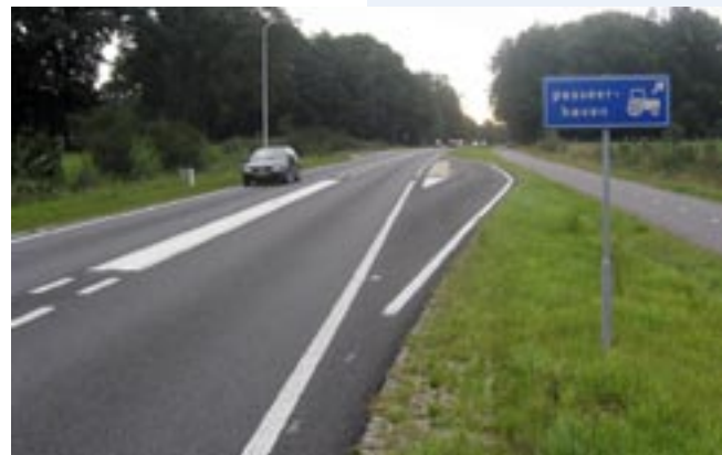
Een compromis: vrijliggende fietspaden met passeerhavens voor het landbouwverkeer (N734).
