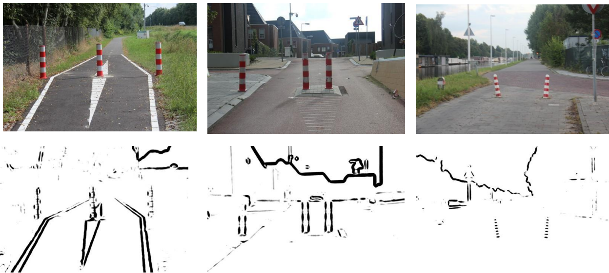
Figuur 8: De markering zoals een slechtziende het waarneemt volgens de IDED-methode. Vlnr de proeflocaties Hardenberg, Barneveld en controlelocatie Utrecht
