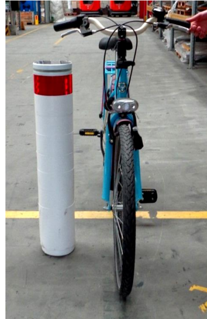
Figuur 11: de stuurhoogte van een kinderfiets vergeleken met een 85 cm hoge paal. Deze testpaal voldoet overigens nog niet aan de eis 50% rood (bron: VelopA)
