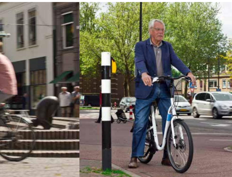
Het zadel van de SOfiets zakt automatisch als de fiets stopt.
