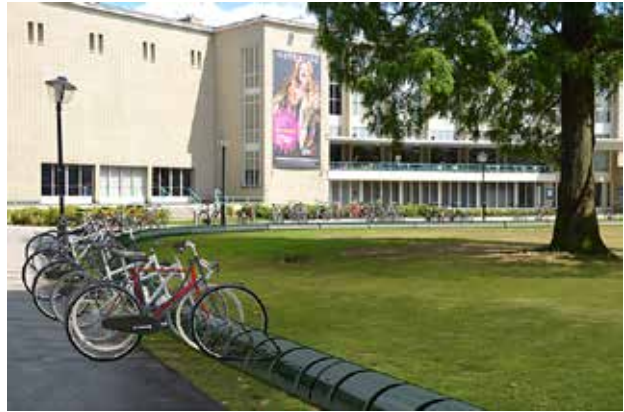
De Wal, een half gebogen staalplaat met 'taartinkepingen' waar de fiets in gezet kan worden.
