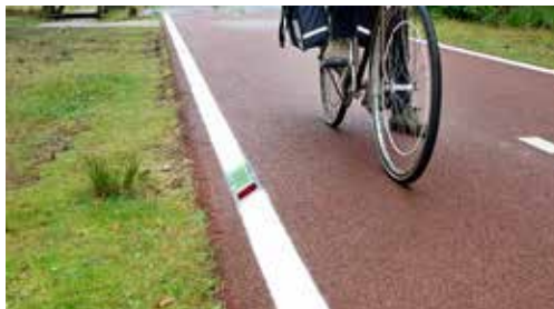
Tilburg beproeft reflectoren die daglicht absorberen om dat 's nachts weer af te geven.
