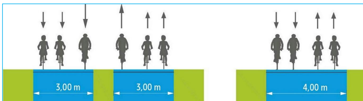
Figuur 4: De minimale breedtes voor label A komen overeen met de CROW-aanbevelingen voor snelle fietsroutes
