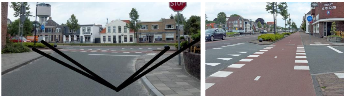
Figuur 7a (links) Ernstige zichtbelemmeringen rechts en links van de zijweg. Op de hoek van de kruising staat rechts een horecagelegenheid met terras en links een woonhuis. Het zichtprobleem is hier beperkt met een stopbord en stopstreep. Figuur 7b (rechts) De horecagelegenheid gezien vanaf het kruisende fietspad.
