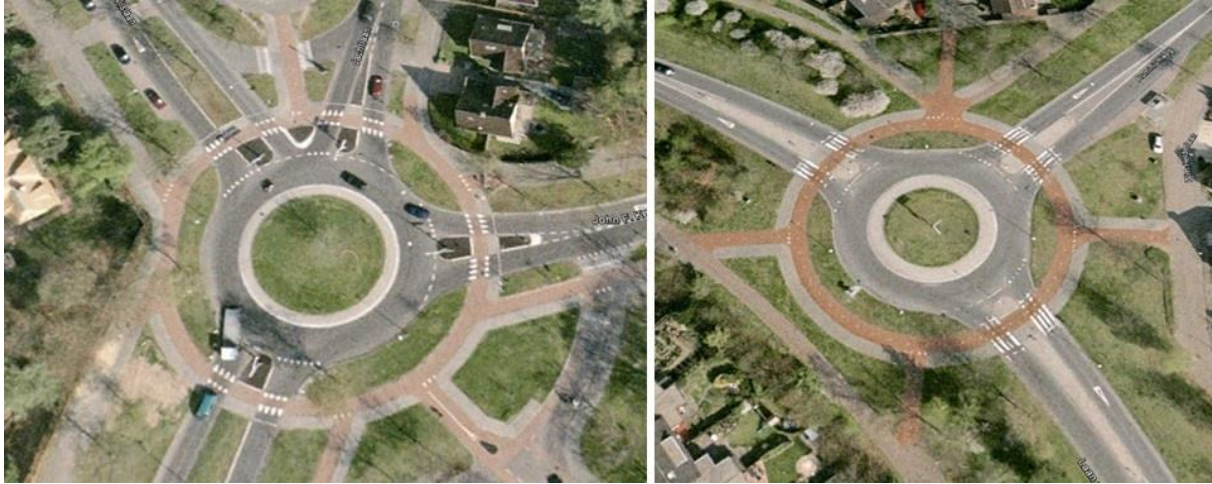
Figuur 4 Rotondes waarop naast wegen ook solitaire fietspaden aansluiten (beide foto's uit Apeldoorn)
